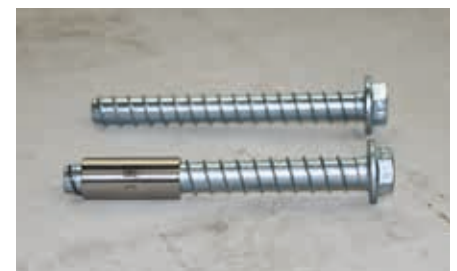
Hülse lässt sich komplett aufstecken, Schraube für Weiterverwendung nicht mehr geeignet
